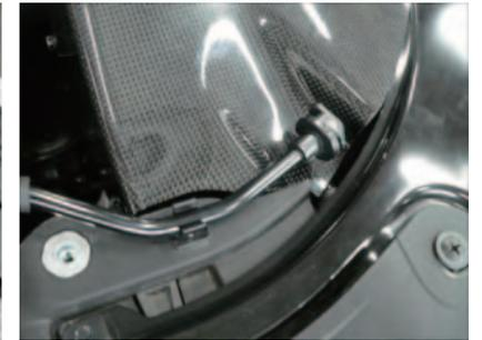
15. ボンネットロックステアを一旦戻し、カーボンケースと干渉しないかを確認します。(干渉する場合はステアを緩めて取付け位置の微調整を行ってください。)
