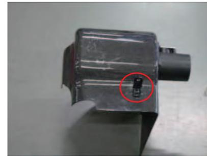
10. ビスBとナットを使用してステア-Aをカーボンケースに取付けます。
