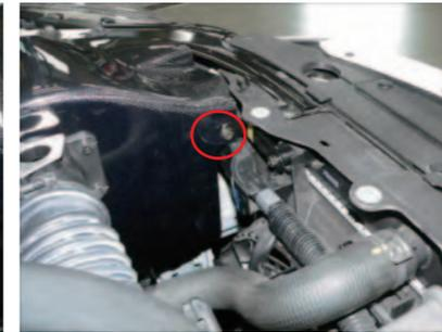
14. ビスBを使用してステア-BとカーボンケースASSYを固定します。
