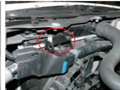
11. スパーサーを挟みビスDでステア-Bを取付けます。
