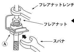
◀左図のようにフレアナットは、必ずフレアナットレンチ(専用工具)を使用しアダプター①を固定しながら締め付けて下さい。
