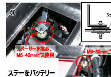
⑯ ステアをバッテリーキャリアステアに固定する際は上下にワッシャーを挟んで、M6ナットで固定します。
