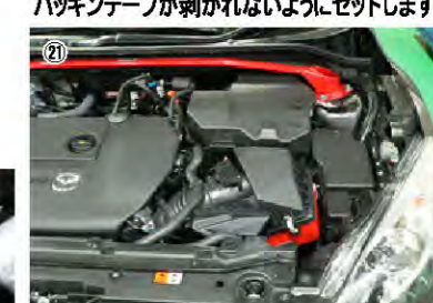
㉒ エアフロセンサーのカバーとホース類を戻し、エンジンカバーを取り付けて、作業完了です。
