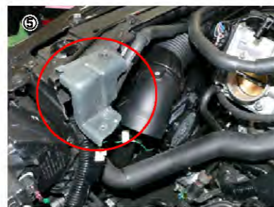
⑤ フレッシュエアダクトとクリーナーケースを固定していたブラケットを取り外します。
