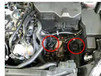
⑥ クリーナーケースを固定していたマウンティングラバーを取り外します。
