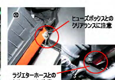
⑳ ヒューズボックスとのクリアランスに注意 ㉑ ラジエーターホースとのクリアランスに注意
