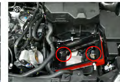
⑮ ステア部分にワッシャー・ボルト・M6ナットを使い、取り付けます。
