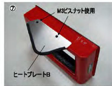
⑦ フィルターカバーにヒートプレートB・ミゾゴムを取り付けます。
