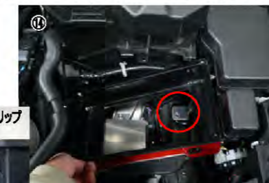
⑭ フィルターカバーをバッテリーキャリアステアの上に配置します。
