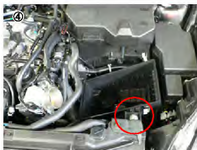
④ ボルトを外し、クリーナーケース下側を取り外します。
