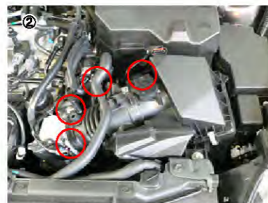
② エアフロセンサーカバーとホース類を外し、スロットル側のバンドを緩め、クリーナーケース上側を取り外します。
