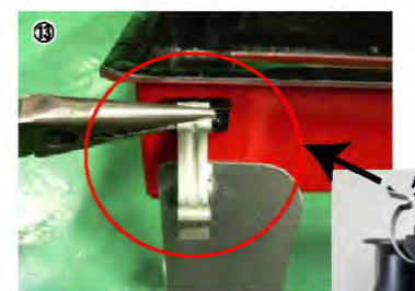
⑬ ノーマルクリーナーケースからクリップを外し、フィルターカバーのブラケットBに入れてプライヤーを挟んで留めます。
