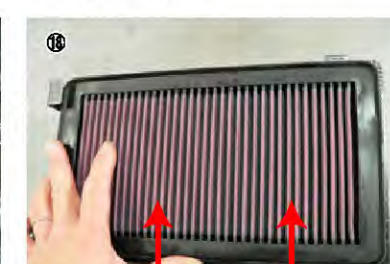
⑱ K&Nフィルターの取り付けは、内側に貼り付けたパッキンテープが剥がれないようにセットします。
