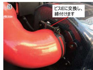
⑲ インテークサクションキットと同時装着する場合は、ホースクランプのボルトをビスEに交換し取付けます。
