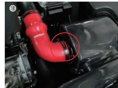
⑱ アッパーケースをロアケースに被せて配置し、エアホースを接続し、クランプで固定します。
