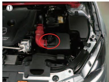
① エアフローセンサーのカブラーを取外し、エアホースのホースクランプを緩めます。
