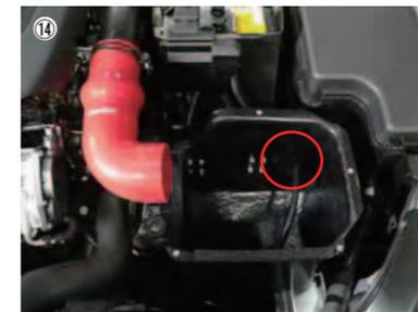
⑭ エアフローセンサーハーネスを穴に通し、ロアケースを車体に取付けます。
