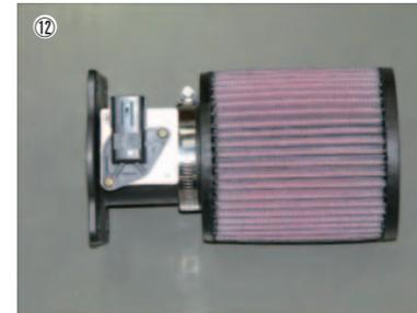
⑫ エアフローアダプターにエアフィルターを取付け、ホースバンドで固定します。
