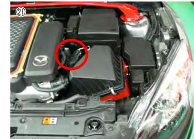
㉑ エアフロセンサーのカバーを元の通りに取り付けて、作業完了です。
