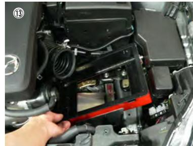
⑬ フィルターカバーをバッテリーキャリアステアの上に配置します。
