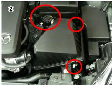
② エアフロセンサーカバーとクリップを外し、クリーナーケース上側を取り外します。
