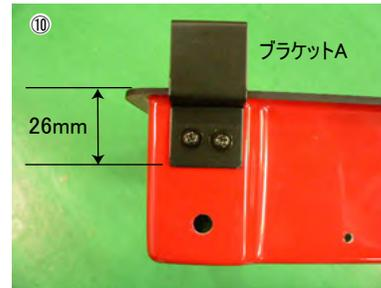
⑩ フィルターカバーにブラケットA・Bを取り付けます。ブラケットの基本取付位置は上図を参照(K&Nフィルターの場合)
