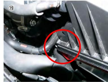
⑲ フィルターカバーの取り付けの際、ヒューズボックス、ラジエーターホースとのクリアランスに注意。
