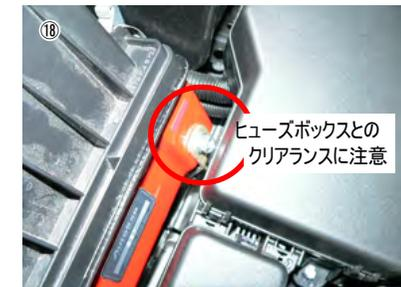
⑱ クリーナーケース上側をエアーストに差し込みます。フィルターカバーに配置します。
