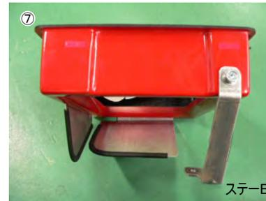
⑦ 写真のようにブラケット・ステア・ヒートプレートを取り付けます。
