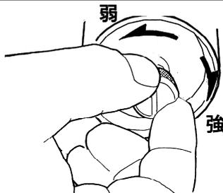
フロントの減衰調整は、ステアリングをどちらか一方に切り、ショックアブソーバー底部にある調整ノブで調整します。
