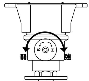
リアの減衰調整は、リアショック上部にある調整ノブで調整します。
