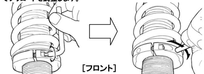
付属のロックレンチを使用してプリロードを調整します。調整する際はあらかじめボトムケースが固定されているアーム類から取り外す必要があります。また、ボトムケースとダンパー本体のカミシロは10mm以上確保してください。
