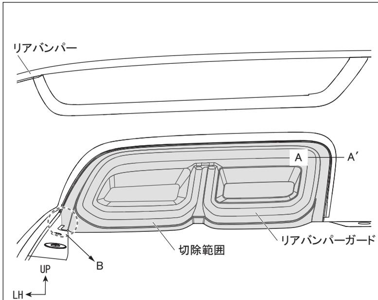
2. リアバンパーの左図指示部を切除加工します。加工後は、切除部周辺のバリを除去してください。
