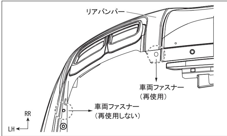
1. リアバンパー下面の車両ファスナーを取り外します。（左右各2ヶ所）
