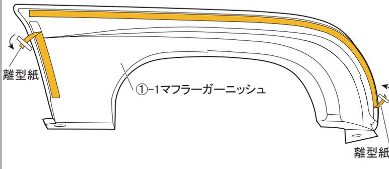
7. ①-1マフラーガーニッシュ裏側の両面テープ離型紙を30mm程度剥がし、表側へ折り返してマスキングテープで固定します。
