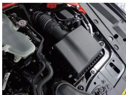
4. エアークリーナーカバーからエアホースを外し、エアークリーナーASSYを取外します。
