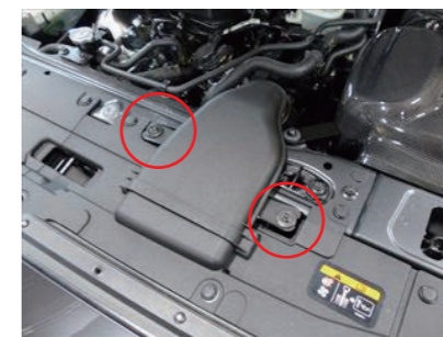
17. フレッシュエアダクトを取外したボルトで固定します。
