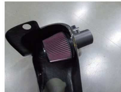
10. エアフィルター ASSYとエアフローアダプターをカーボンケースを挟み込むようにビス Bx4で固定します。
