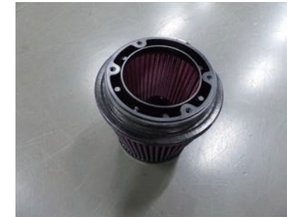
9. ファンネルアダプターにエアフィルターを取付け、バンドで締めつけ固定します。
