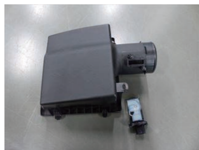
5.アークリーナーカバーからエアフロセンサーを取外します。
