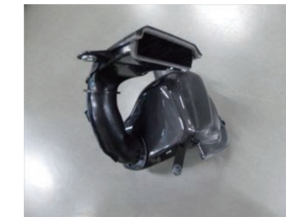
15. 取外したフレッシュエアガイドをカーボンケースに仮付けします。
