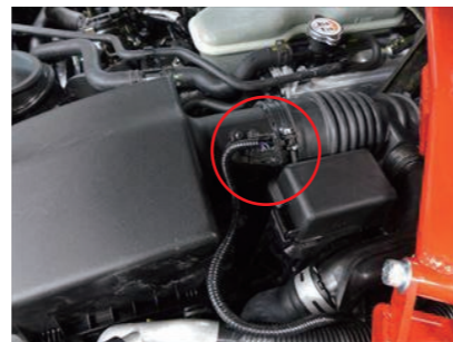
3.エアフローセンサーコネクタとエアフローセンサーの配線留めを外します。エアホースクランプを緩めます。
