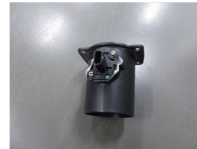
8. エアフローアダプターにスペーサーを挟み、ビスCx2でエアフローセンサーを取付けます。
