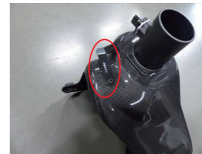
14. カーボンケースにビス Ax1 を使用してステー B を取付けます。
