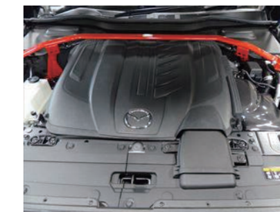
18. エンジンカバーを戻します。エンジンカバーと干渉する場合クッションテープを貼ってください。
