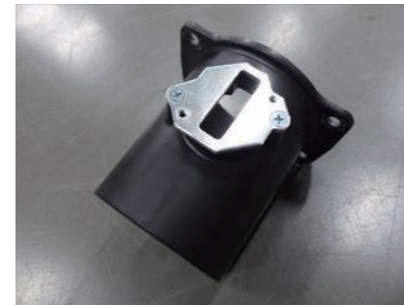
7. ビスDx2を使用して、エアフローアダプターに変換プレートを取付けます。
