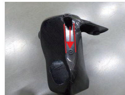
13. カーボンケースの形に添ってステー A をビス Ax1 を使用して取付けます。ステーは出来るだけ下げて取付けて下さい。
