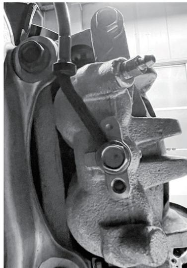
7. サスペンションをフルバンプ、フルリバウンド、またそれぞれのストローク状態でステアリングをロックウロックまで据切りし、ブレーキラインに無理な力が掛かったり、車両各部と干渉していないかを確認します。
