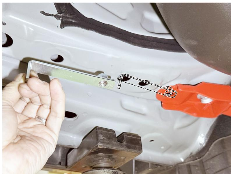
9. 8と同様の手順で、⑨リアメンバーブレースNo.2 LH を取付けます。
