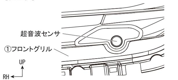
12. フロントバンパーに4. で取り外した車両ファスナー(再使用、左右各3ヶ所)を使用し、①フロントグリルを取り付けます。その際、整備書を参照し、コネクタ類も取り付けます。
