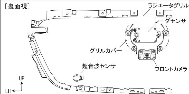
5. 整備書を参照し、ラジエータグリルからグリルカバー、フロントカメラ、レーダセンサ、超音波センサを取り外します。
