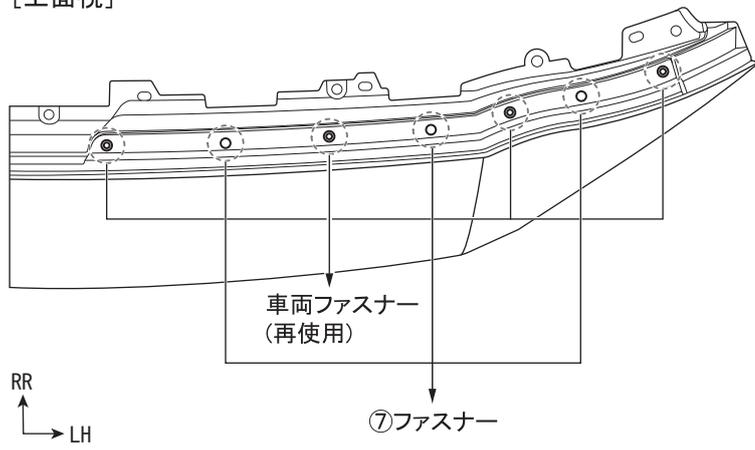
14. フロントバンパーに2. で取り外した車両ファスナー(左右各4ヶ所)と⑦ファスナー(左右各3ヶ所)を使用し、アッパーフェースを取り付けます。
