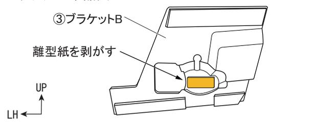
11. ①フロントグリルに10. で組付けた③ブラケットBを仮あてし、③ブラケットBの両面テープ離型紙を外側へ引き抜きながら貼付け面を十分に圧着します。その際、表面視で①フロントグリルの穴と超音波センサが同心となるよう合わせます。
