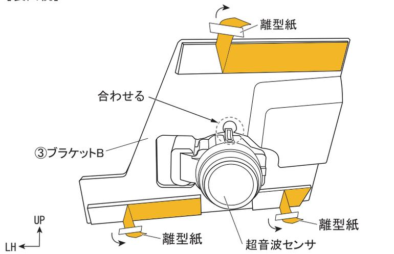
10. ③ブラケットB凹部両面テープ離型紙を剥がし、5. で取り外した超音波センサを貼り付けます。その際、③ブラケットBの切り欠きと超音波センサの凸部を合わせます。
