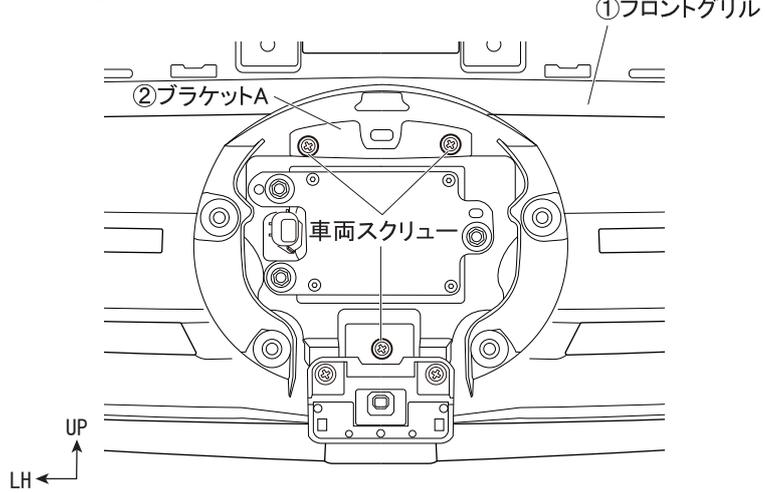
9. ①フロントグリルに、8. で組み立てた②ブラケットAを6. で取り外した車両スクリュー(再利用、計3ヶ所)で取り付けます。
