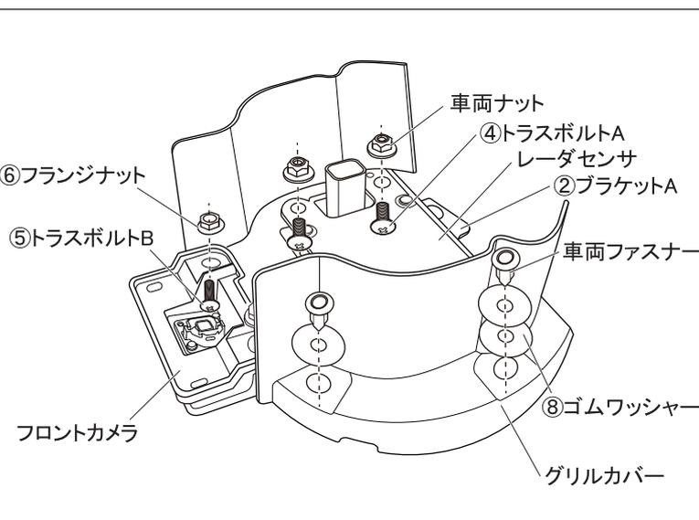
8. ②ブラケットAに5. で取り外した、グリルカバーを車両ファスナー(再利用、左右各2ヶ所)と⑧ゴムワッシャー(左右各上側2枚、下側1枚)、フロントカメラを⑤トラスボルトB(左右各1ヶ所)と⑥フランジナット(左右各1ヶ所)、レーダセンサを④トラスボルトA(計3ヶ所)と車両ナット(計3ヶ所)で取り付けます。
