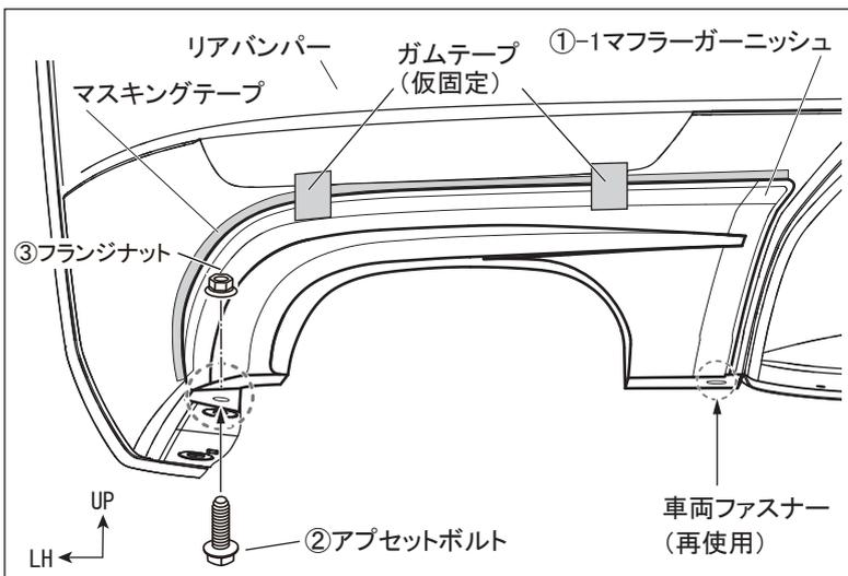
3. ①-1マフラーガーニッシュを車両に仮あてし、1.で取り外したリアバンパー下面の車両ファスナー（左右各1ヶ所）、②アプセットボルトと③フランジナット（左右各1ヶ所）で仮締めし、ガムテープ等で仮固定します。
