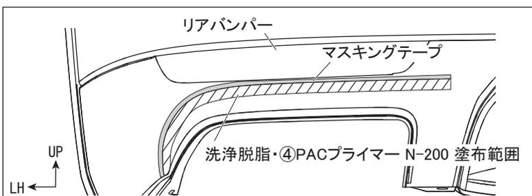
6. リアバンパーの両面テープ貼り付け部（左図斜線部）を洗浄脱脂し、④PACプライマー N-200 を塗布します。
