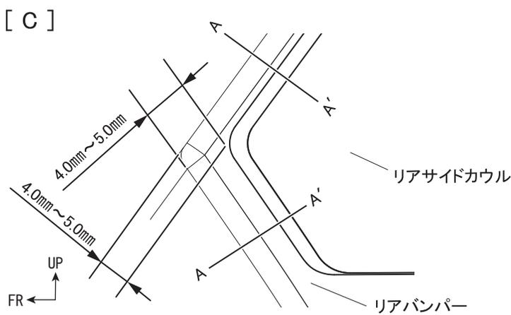
C. B.同様、端部の距離が指示寸法に収まるよう位置を調整します。
