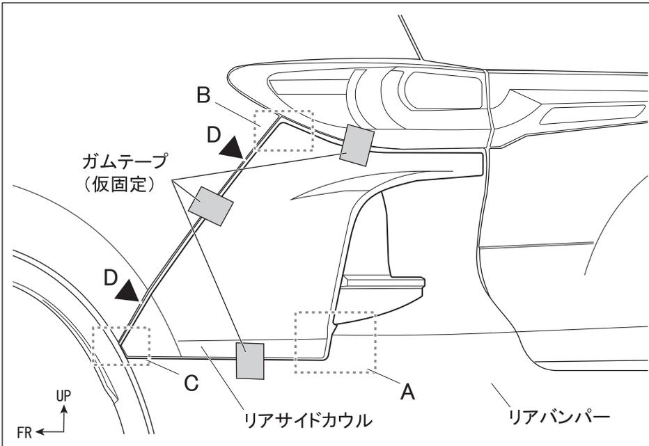
1. リアバンパーにリアサイドカウルを仮あてし、ゴムテープ等で仮固定します。この際、コーナーA→B→Cの順で、リアサイドカウルとリアバンパーの端部の距離を指示寸法に収めるよう調整しながら位置を決めます。
