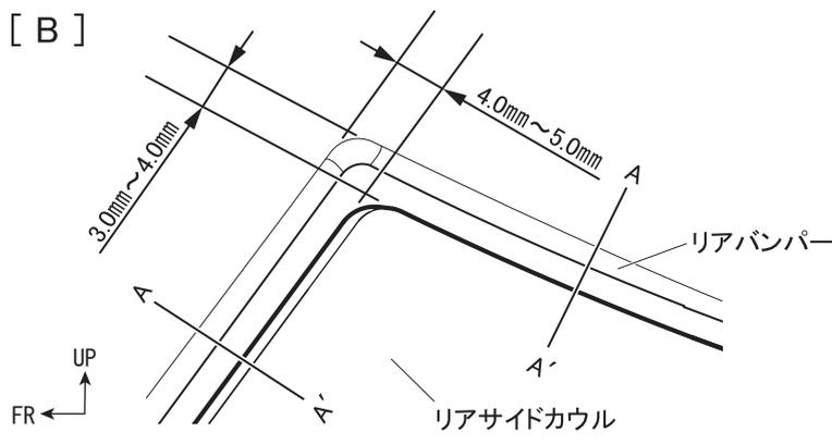
B. リアサイドカウルとリアバンパーの2辺、各端部の距離が指示寸法に収まるよう位置を調整します。
