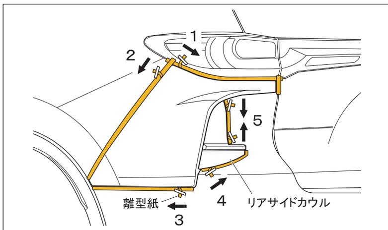
6. 車両側に貼り付けた取り付け位置マーキングに合わせてリアサイドカウルをあてがい、位置がずれないように両面テープ離型紙を左図矢印の方向と順番で引き抜きながら貼り付け面を十分に圧着します。
