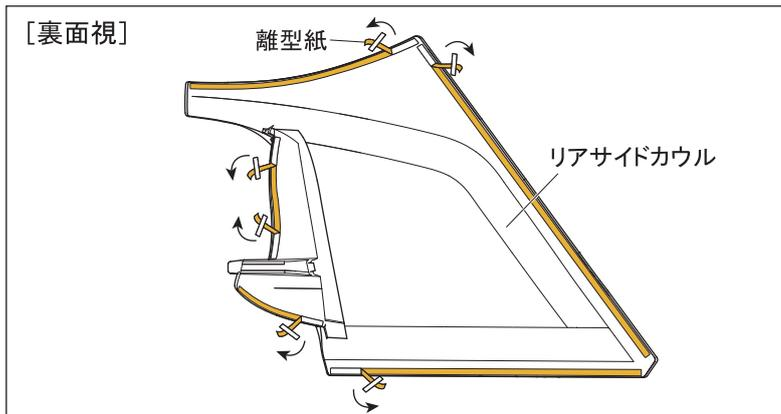
5. リアサイドカウル裏側の両面テープ離型紙を30mm程度剥がし、表側へ折り返してマスキングテープで固定します。（左右各6ヶ所）
