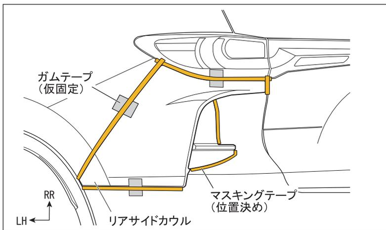
2. 左図のようにリアサイドカウル端部を基準にマスキングテープを貼付け、製品取り付け位置をマーキングします。
