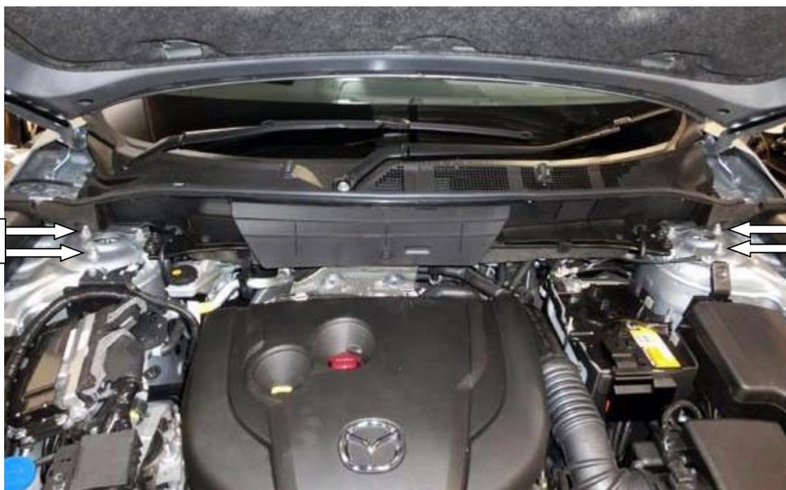
2. ①フロントタワーバーを取付けし、②フランジナットを使用して固定し作業完了です。
