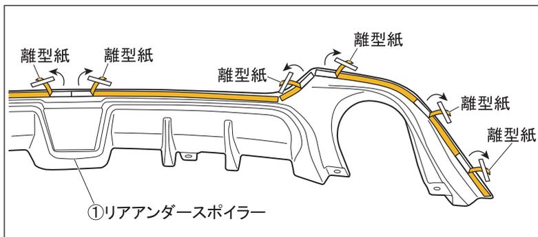
9. ①リアアンダースポイラー裏側の両面テープ離型紙を 30mm 程度剥がし、表側へ折り返してマスキングテープで固定します。(左右各 5ヶ所)
