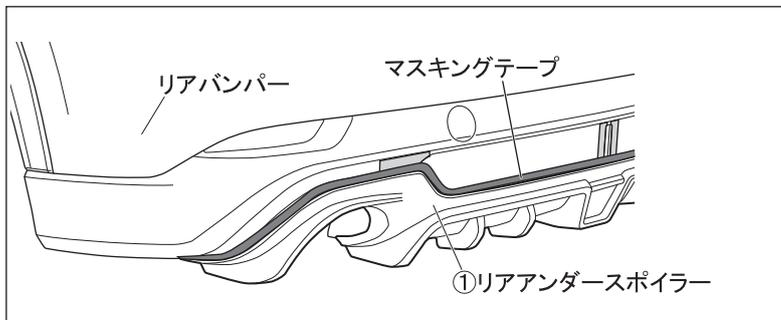
5. ①リアアンダースポイラーの上端に合わせてリアバンパーにマスキングテープを貼り付けます。
