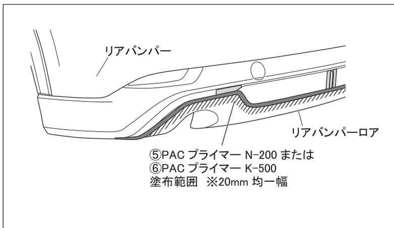
8. 両面テープ貼付け部 (左図斜線部) に⑤PAC プライマー N-200 (グレードにより⑥PAC プライマー K-500 一部使用) を塗布します。
