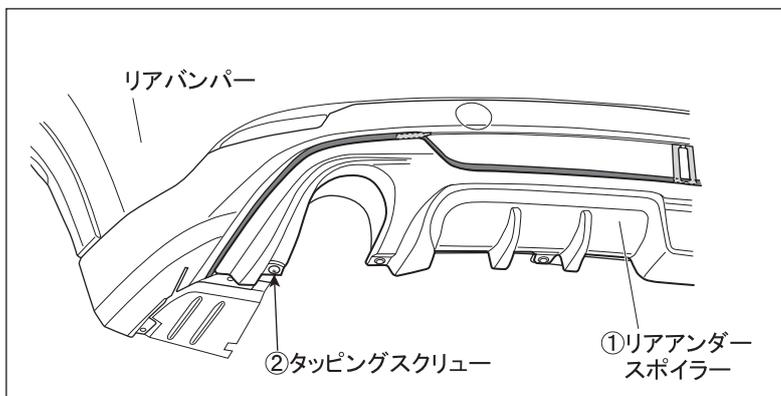
12. 10. で仮固定した②タッピングスクリュー（左右各1ヶ所）を本締めします。
