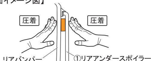
11. ①リアアンダースポイラーの両面テープの離型紙を左図の順番で引き抜きながら貼り付け面を十分に圧着します。
