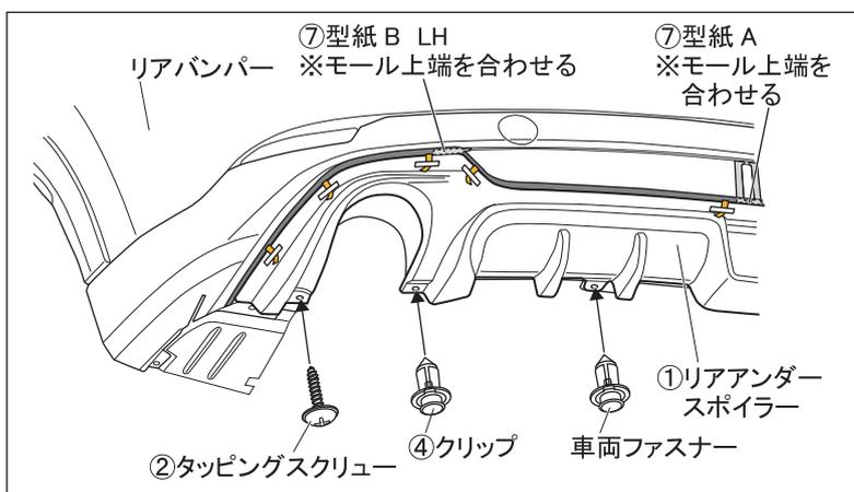
10. リアバンパー後面に貼り付けた⑦型紙 A、B (RH/LH) のモール高さに合わせて①リアアンダースポイラーをリアバンパーに仮あてし、②タッピングスクリュー (左右各 1ヶ所、仮締め)、④クリップ (左右各 1ヶ所)、2. で取り外した車両ファスナー (左右各 1ヶ所) で仮固定します。
