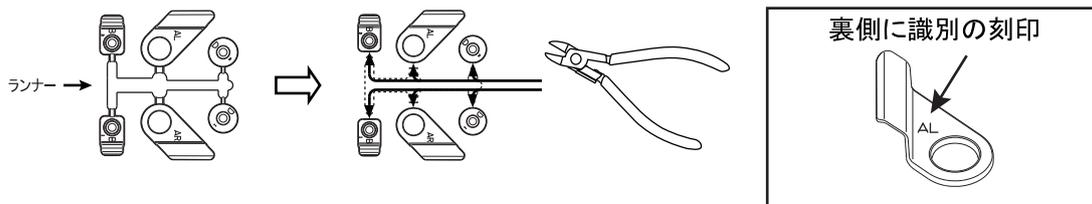
6. 下図に従い、バイザーに③ブラケットを組付けます。バイザーの開口穴に合わせてバイザー裏面から③ブラケット AL、B をセットし、③ブラケット AL に③樹脂ワッシャー D をセットします。バイザー表面から④ブラケットピンを挿入して固定します。
