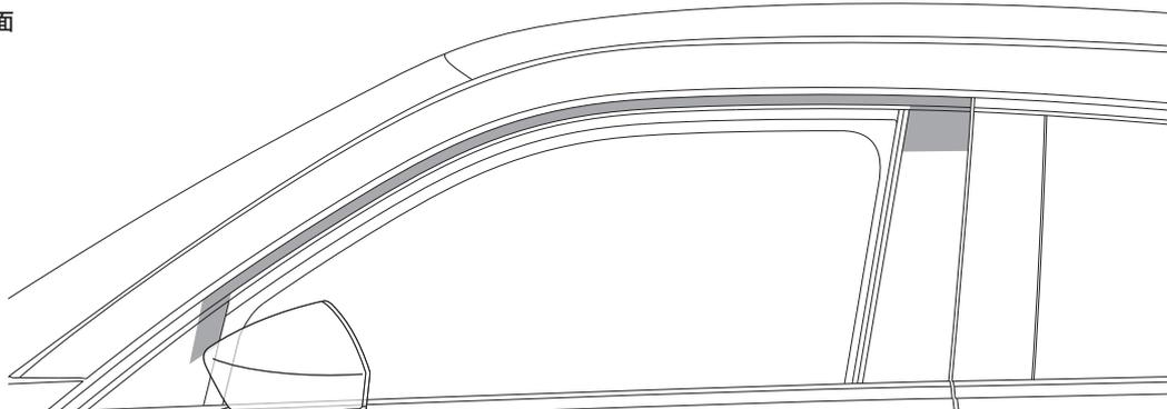
3. バイザー裏面の両面テープの離型紙を下図を参考に30mm程度剥がし、外側に折り曲げます。◎部のみ全て剥がします。
