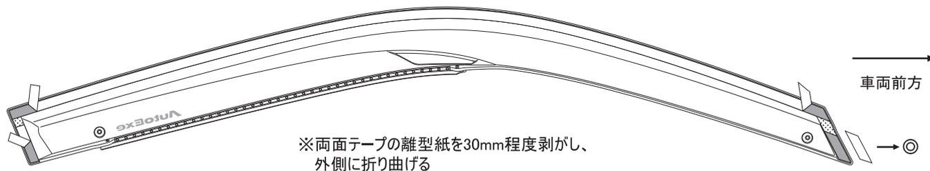
4. 下図の示す位置を参考に、フロントバイザーは後端をドアパネル後端から2mm、上端をドアパネルから2mm 内側に合わせ仮付けします。
