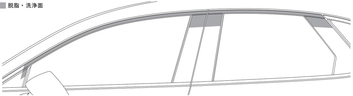
3. バイザー裏面の両面テープの離型紙を下図を参考に30mm程度剥がし、外側に折り曲げます。◎部のみ全て剥がします。
