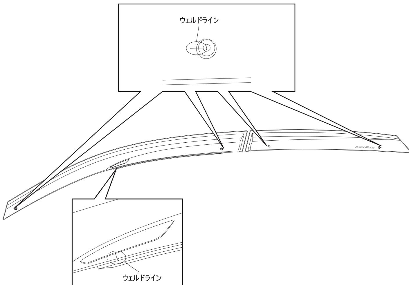
※ バイザーの開口部とブラケットピンを差し込む穴の横にあるラインは樹脂の
