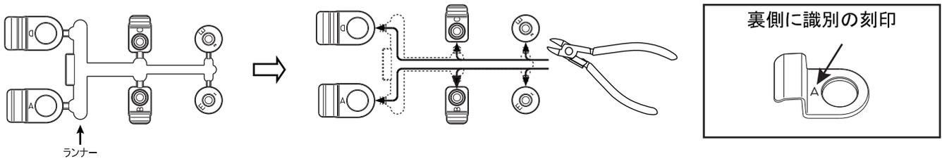
6. 下図に従い、各バイザーに⑤ブラケットを組付けます。バイザー開口穴に合わせてバイザー裏面から⑤ブラケット A、B、C、D をセットし、⑤ブラケット A、D に⑤樹脂ワッシャー E をセットします。バイザー裏面から⑥ブラケットピンを挿入して固定します。
