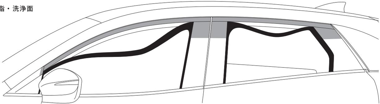
4. バイザー裏面の両面テープの離型紙を下図を参考に30mm程度剥がし、外側に折り曲げます。◎部のみ全て剥がします。
