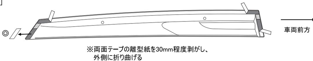
5. 下図の示す位置を参考に、フロントバイザーは後端をドアパネル後端から3mm、上端をドアパネルから2mm 内側に合わせ仮付けします。リアバイザーは、前端をドアパネル前端から3mm、上端をドアパネルから2mm 内側に合わせ、仮付けします。
