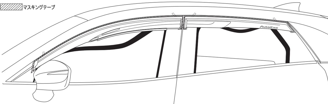
7. フロントバイザー、リアバイザーを一旦外し、下図を参考にフロント・リアの外周から13mm内側にマスキングテープを貼付けます。マスキングテープで囲んだ面が両面テープ貼付面となるので、貼付面に⑦プライマーを塗布します。
