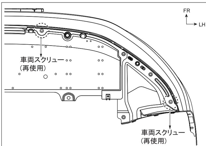
2. フロントバンパー下面の車両スクリューを取り外します。(左右各2ヶ所)
