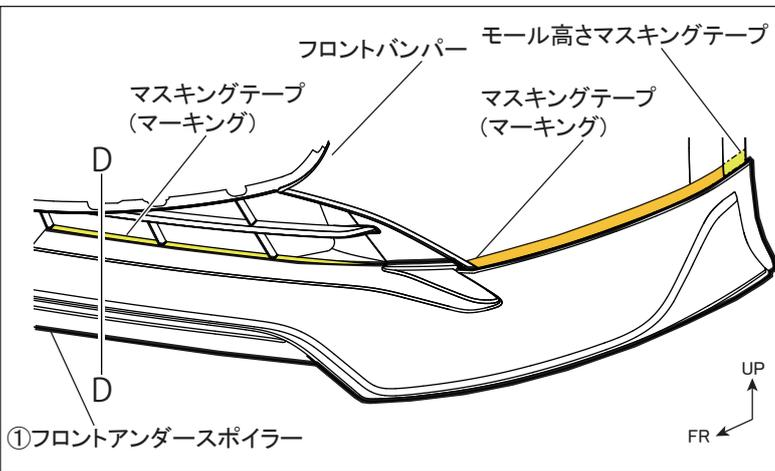
11. ①フロントアンダースポイラーのモール上端と、D-D断面図の指示に合わせて、フロントバンパーにマスキングテープ(マーキング)を貼り付けます。
