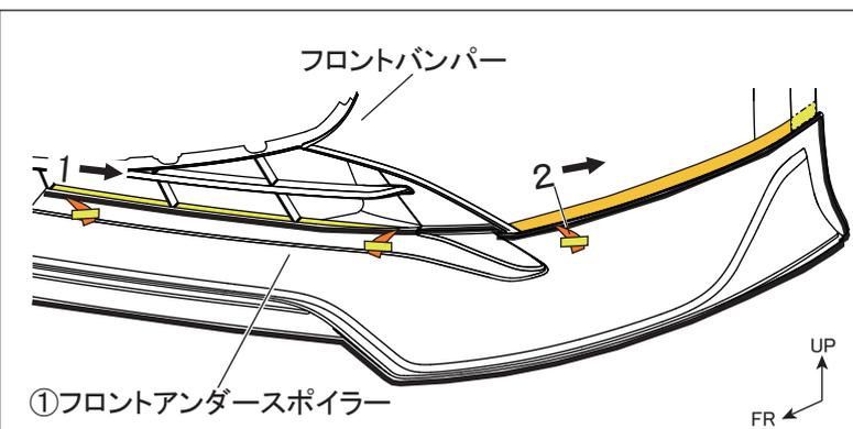
16. ①フロントアンダースポイラーの両面テープの離型紙を中央から外側絵へ左図の順番で引き抜きながら貼り付け面を十分に圧着します。
