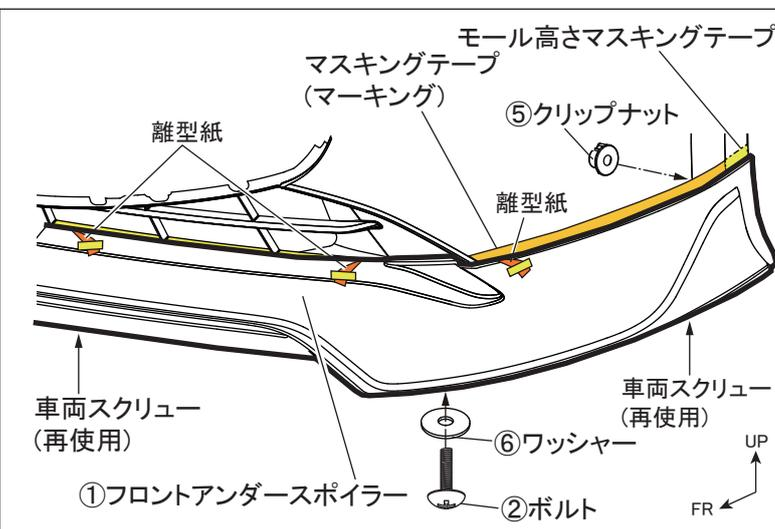
15. ①フロントアンダースポイラーを車両に仮当てし、車両スクリュー(再使用、左右各2ヶ所)、②ボルトと⑥ワッシャー(左右各1ヶ所)を仮締めし、⑤クリップナット(左右各1ヶ所)をフェンダーカバーをめくり仮締めします。①フロントアンダースポイラーを車両に貼り付けたマスキングテープ(マーキング)に合わせて、位置を決めます。
