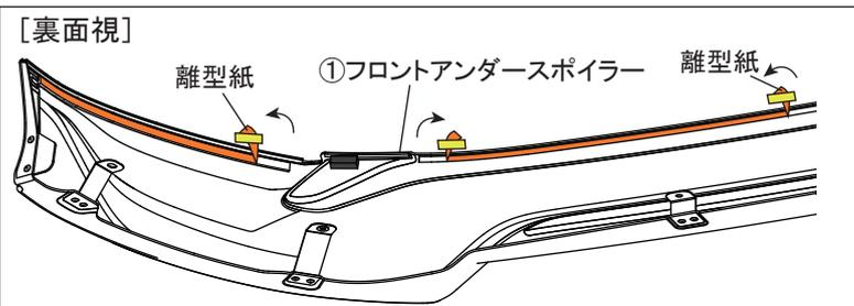
14. ①フロントアンダースポイラー裏側の両面テープ離型紙を製品中央から30mm程度剥がし、表側へ折り返してマスキングテープで固定します。(左右各3ヶ所)
