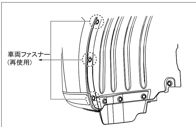
3. フロントフェンダーカバーの車両ファスナーを取り外します。(左右各3ヶ所)
