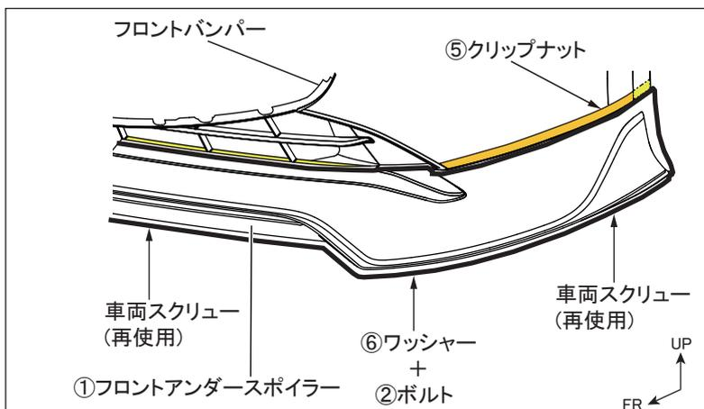
17. 15.で仮固定した車両スクリュー（再使用、左右各2ヶ所）
