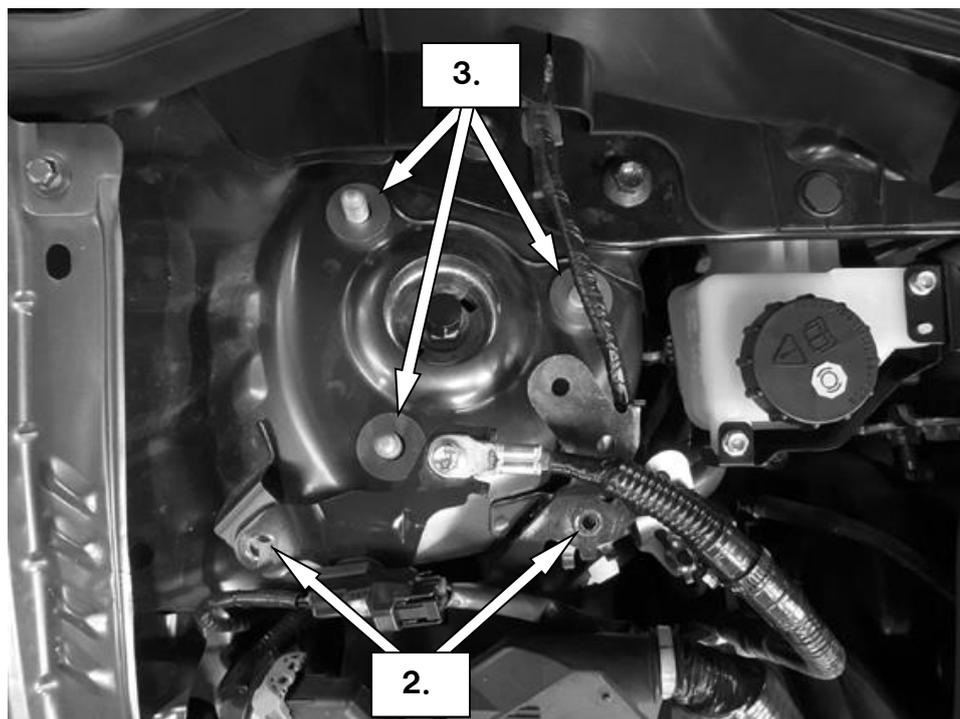
4. 右ストラット部にあるハーネスステーを手でかわしながら①フロントタワーバーを車両に取付け、③フランジナットを使用して固定します。(締付トルク: 49~59N・m)
