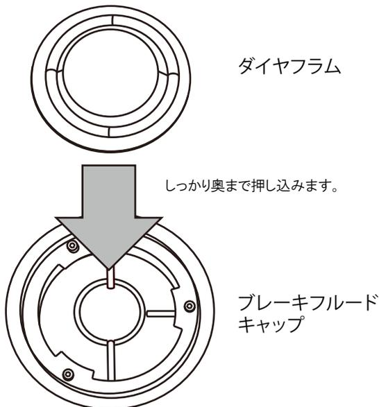
3. ブレーキマスターシリンダータンクへ①ブレーキフルードキャップ(ダイヤフラムセット済み)を時計回りで締付け、フックが確実にロックしていることを確認し作業は完了です。
