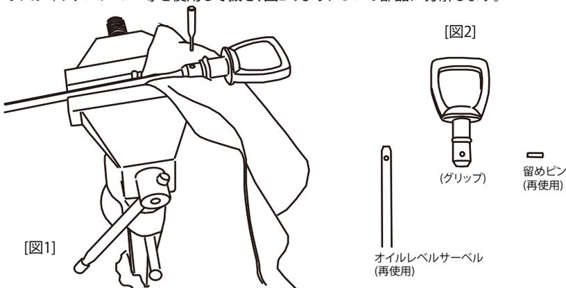
2. オイルレベルゲージを組み立てます。まず図3のようにオイルレベルサーベルの上端部に②クリップを差し込みくわえさせます。
