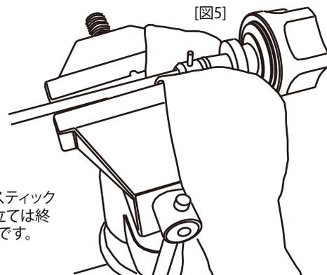
4. 図5のように1で外した純正留めピンを穴に差し元の位置までプラスチックハンマー等を使用して圧入し組み立ては終了です。エンジンに戻し作業は完了です。
