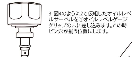
3. 図4のように2で仮組したオイルレベルサーベルを①オイルレベルゲージグリップの穴に差し込みます。この時ピン穴が揃う位置にします。
