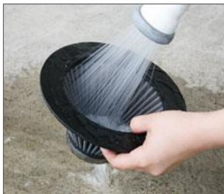
4. フィルターのエンジン側から外側へ、弱い水流ですすぎます。(この時、絶対に強い水圧ですすぎないで下さい。) 汚れが残っている場合は、2~4.の作業を繰り返します。
