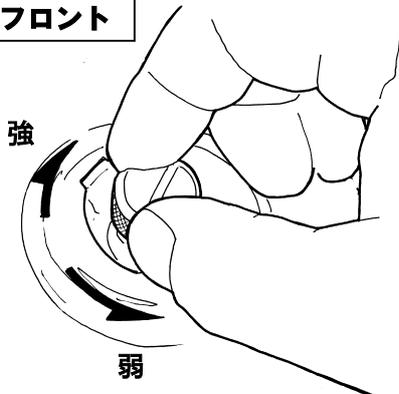
アジャスターを強くする方向に一杯に締め込んだ状態が最強になります。（この時、軽く締め込んで下さい。強く締め込むと内部パーツが破損する恐れがあります。）
