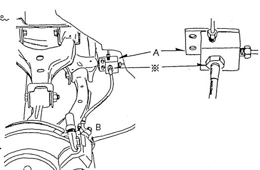
※ 規定のトルクでフレアナットを締め付けてもフルードのにじみ等が発生する場合は、フレアナットの増し締めを行って下さい。
