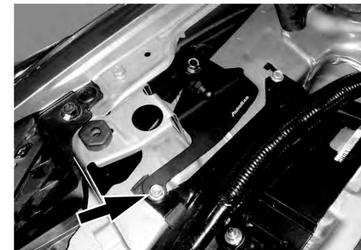
締付トルク ⑥M8フランジボルト 12N・m ⑦M6アプセットボルト 5N・m
