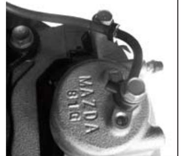
\* 純正ブレーキホースからブラケット（黒色）を取り外し、製品の間固定金具に取り付けます。
