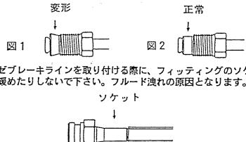
△ 警告 オートエクゼブレーキラインを取り付ける際に、フィッティングのソケット部分を締め付けたり、緩めたりしないで下さい。フレード洩れの原因となります。
