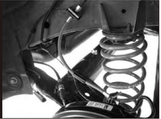
\* ブレーキラインのねじれに注意しながらブレーキホースホルダーにセットし、フレアナットを仮締めします。
