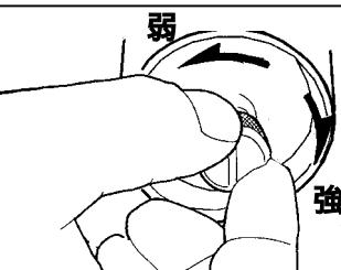
フロントの減衰調整は倒立式の為、ステアリングをどちらかに切り、下側に手を入れて調整します。
