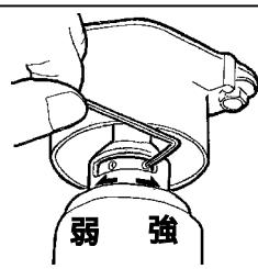
リアの減衰調整はジャッキアップしてタイヤとフェンダーの隙間から手を入れて調整します。
